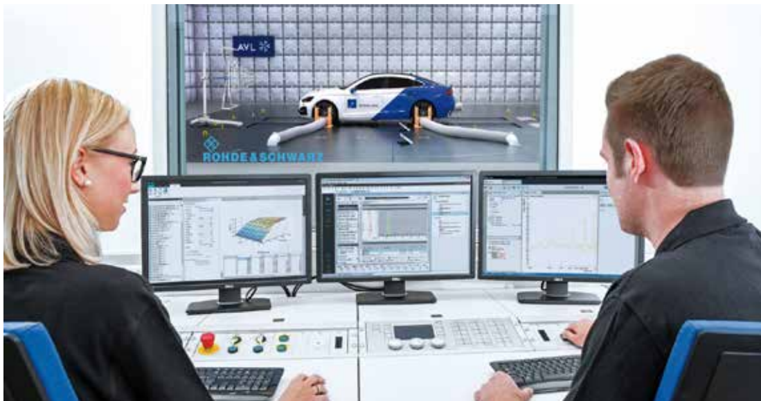
รูปที่ 3 การวัด EMC ในห้องปฏิบัติการ Figure 3. EMC measurements in the laboratory.
