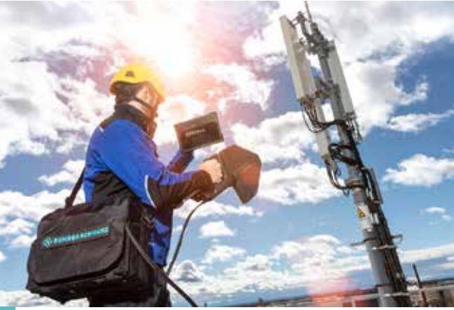
รูปที่ 4 การวัด EMC ในพื้นที่ปฏิบัติงาน
