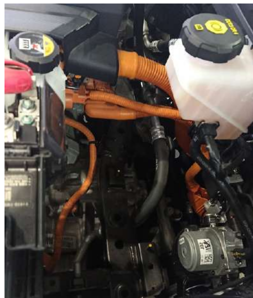
Figure 5. orange high voltage cable รูปที่ 5 สายไฟฟ้าแรงสูงที่เป็นสายสีส้ม
