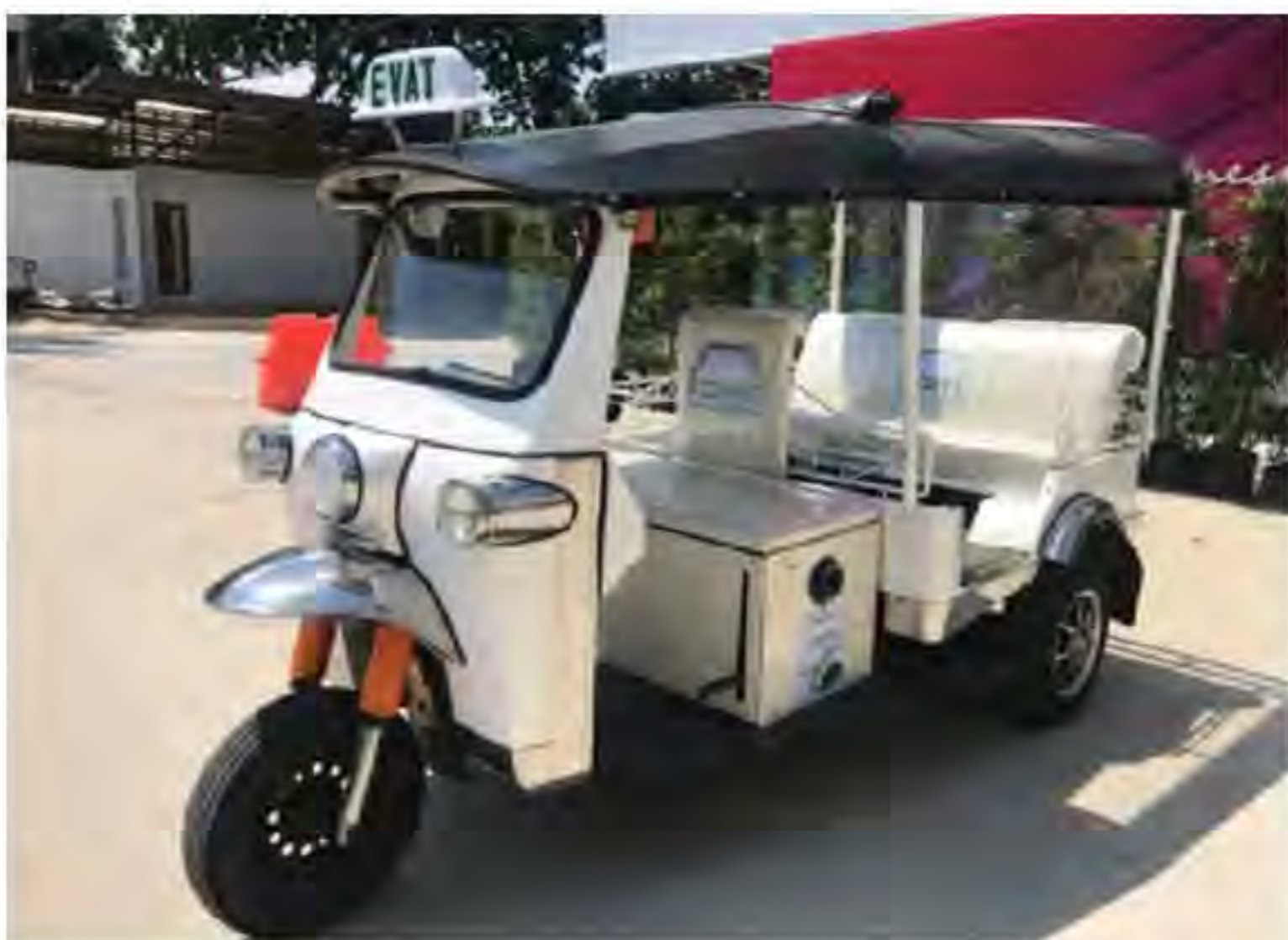
สภาพ หลังการดัดแปลง เป็นรถตุ๊กตุ๊กไฟฟ้า
