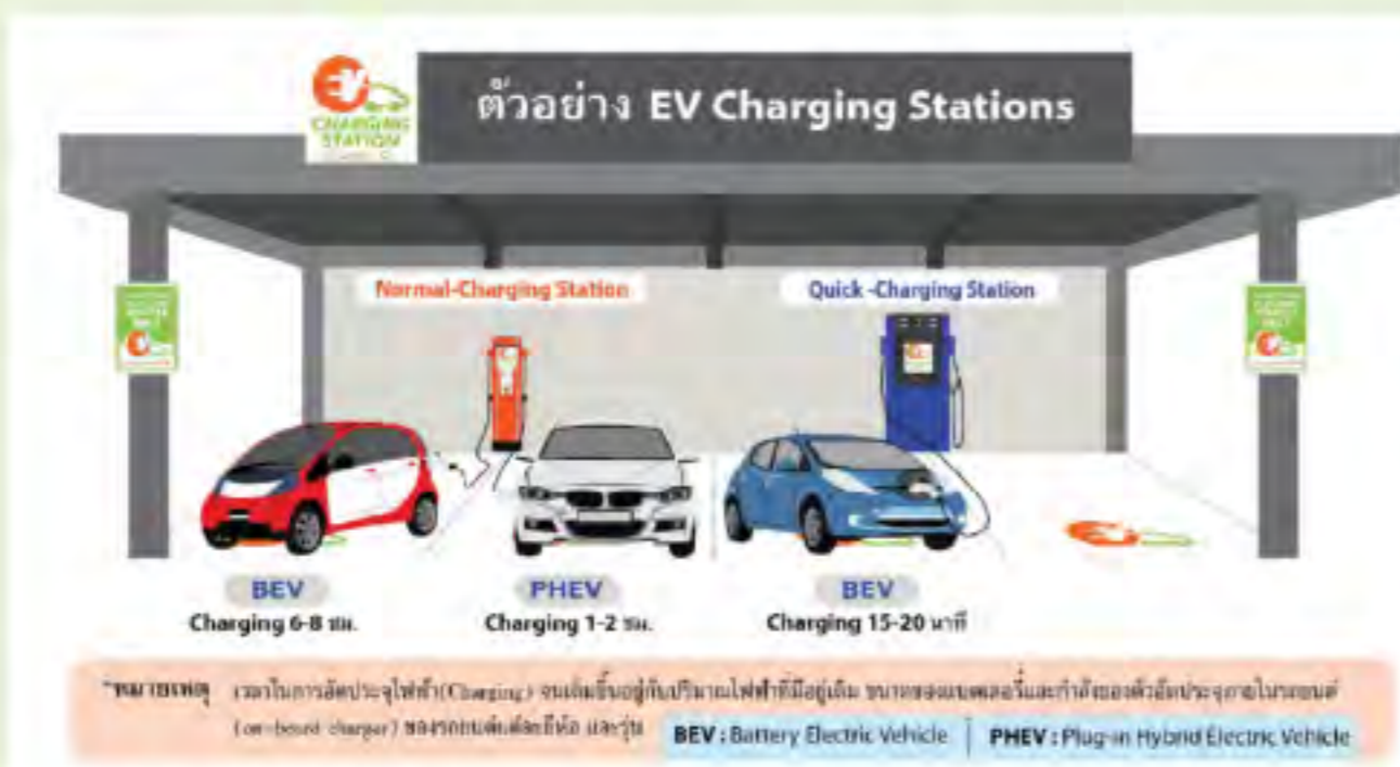
ตัวอย่างสถานีอัดประจุไฟฟ้าในโครงการ
